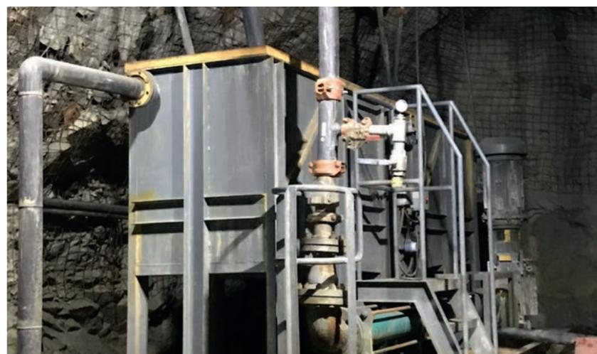
Unidade Dewatering NETZSCH para uma mina de ouro em Montana, EUA
