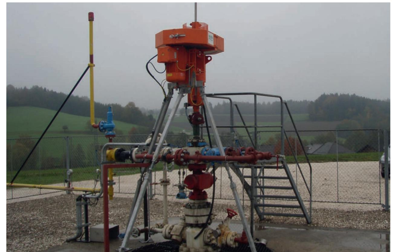
Sistema PCP NETZSCH usado para drenagem de um poço de extração de gás na Áustria
