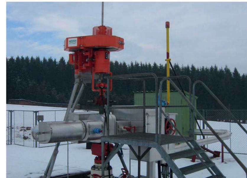
Bomba na aplicação de metano com monitoramento e controle remoto opcional de poço
