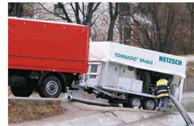
Una unidad móvil TORNADO® que ofrece la posibilidad de remoción rápida y flexible de gran cantidad de diferentes líquidos. Caudal de hasta 1.000 m<sup>3</sup>/h y presión hasta 6 bar.
