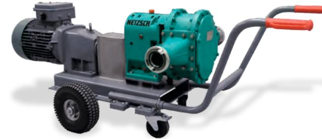
La bomba móvil TORNADO® en unidad extractora de grasa. Una mezcla de grasa y agua residual se bombea a un caudal de 50 m<sup>3</sup> / h y bajo presión de 3 bar.
