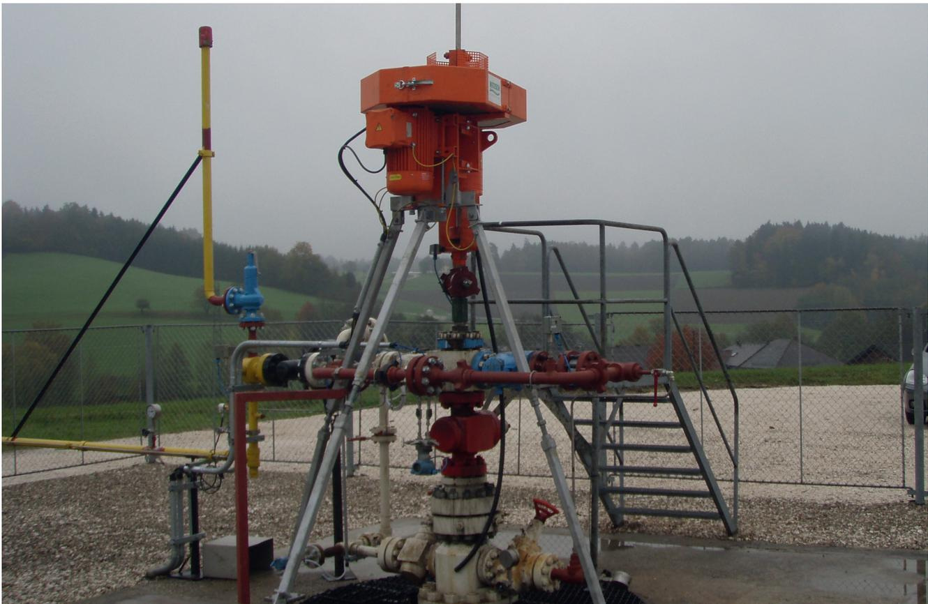
Sistema PCP NETZSCH deshidratación de un pozo de gas en Austria
