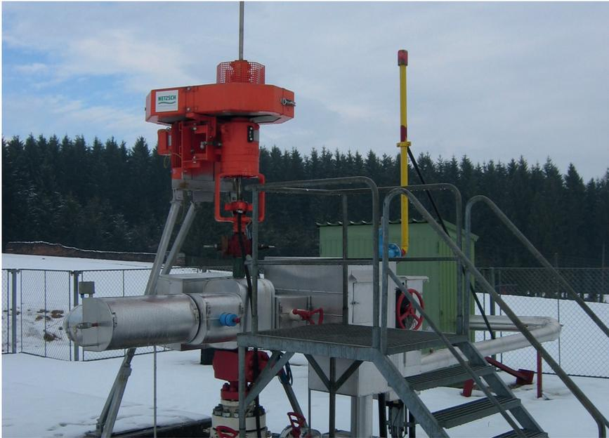
Bomba en una aplicación de metano con monitoreo y control de pozo remoto opcional
