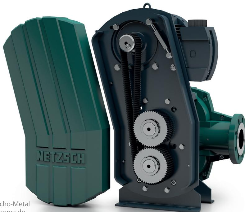
Vista trasera de Bomba Caucho-Metal TORNADO® T2: utiliza una correa de accionamiento dentada robusta y de fácil mantenimiento.
