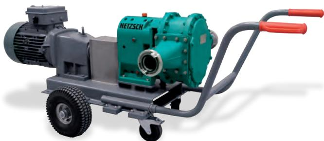
A bomba móvel TORNADO® em unidade extratora de gordura. Uma mistura de gordura e água residual é bombeada a uma vazão de 50 m<sup>3</sup>/h e sob pressão de 3 bar.
