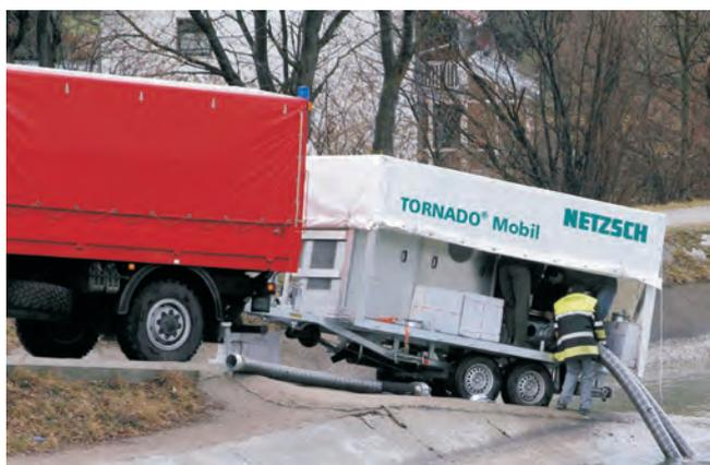
Unidade móvel TORNADO® possibilita a remoção rápida e flexível de grandes quantidades de diferentes líquidos. Vazões de até 1.000 m<sup>3</sup>/h sob pressões de até 6 bar.
